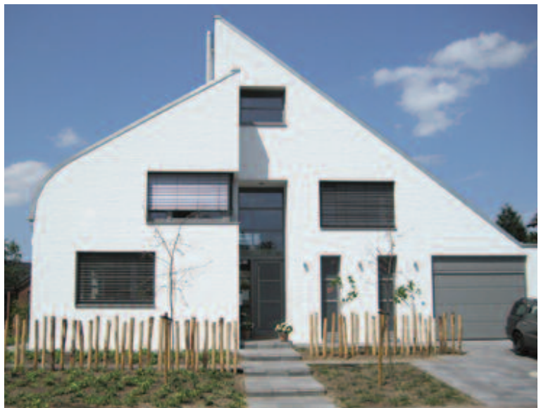
Merantihouten kozijnen, grijs gelakt, met geïntegreerde jaloezieën.
